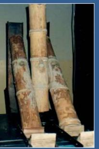
El modelo de unión probado consistió de tres elementos de caña unidos entre sí por un perno: dos elementos laterales inclinados y un elemento central vertical, sobre el que se aplicaba una fuerza, hasta que se producía la falla de uno de sus elementos. Se probaron diferentes ángulos de unión: 30, 45 y 60 grados, y se emplearon pernos de acero de dos diámetros: 1/4" y 3/8".
